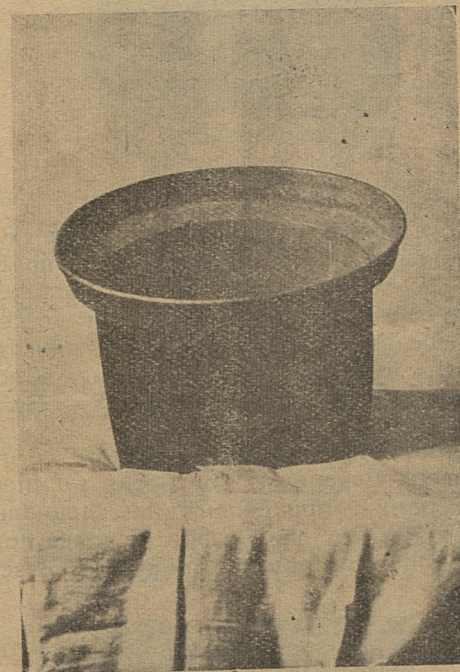
Фиг. 6 Казанче за разваряване на пашкулитъ
