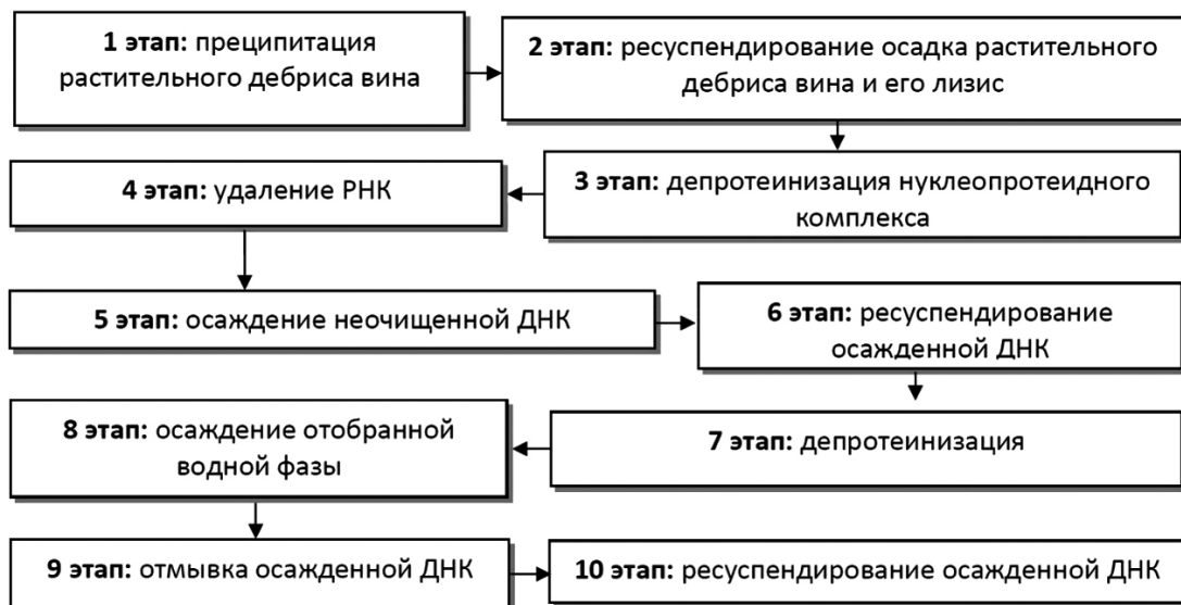
Рис. 1. Этапы пробоподготовки и выделения ДНК Vitis vinifera L. из вина методом Pereira
